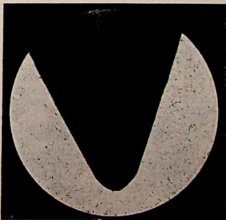
Afb. 83 - EEN VERSLETEN SAFFIER van de achterzijde gefotografeerd (Foto: Philips)
